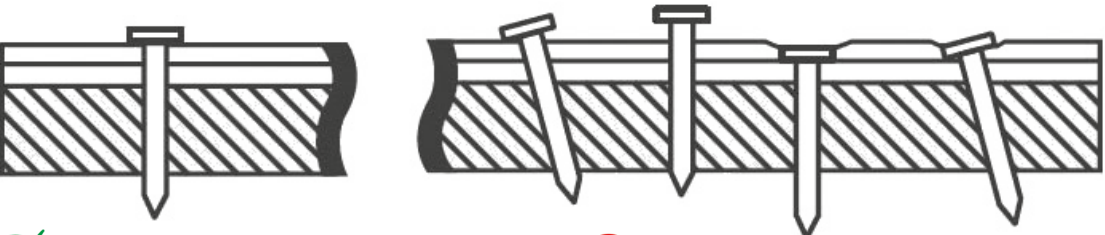
Рис. 3. Пример правильной забивки гвоздей при монтаже продукции.
